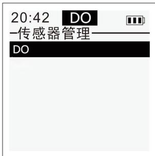
在未连接传感器时，传感器管理界面显示“无传感器”。当成功连接传感器时，则界面会显示当前传感器名称。传感器管理包括传感器校准、参数设置和传感器信息等功能。
