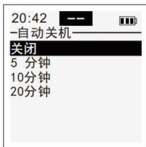
在开启自动关机模式时，若达到设置的自动关机时间，且无按键功能操作，仪表将会自动关机。“关闭”模式是取消自动关机功能，自动关机模式阶段间隔时间有：5分钟、10分钟和20分钟。
