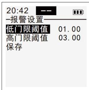
在已成功连接传感器的状态，可设置报警功能的开启与关闭。
