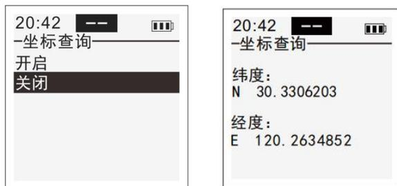
坐标查询功能可以打开或者关闭（默认关闭）。此功能开启后，当设备在户外使用时，可查询当前所处位置的纬度和经度信息。当在此功能开启的情况下进行数据保存时，则其坐标信息也会同步保存。
