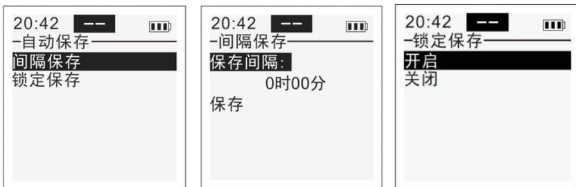
自动保存包括间隔保存和锁定保存两个功能。间隔保存即设置仪器自动保存数据的间隔时间，设置为0则表示关闭该功能，最小间隔时间为1分钟。锁定保存功能即当某参数的测量值锁定时（包含自动锁定和手动锁定），则自动保存该测量数据。
