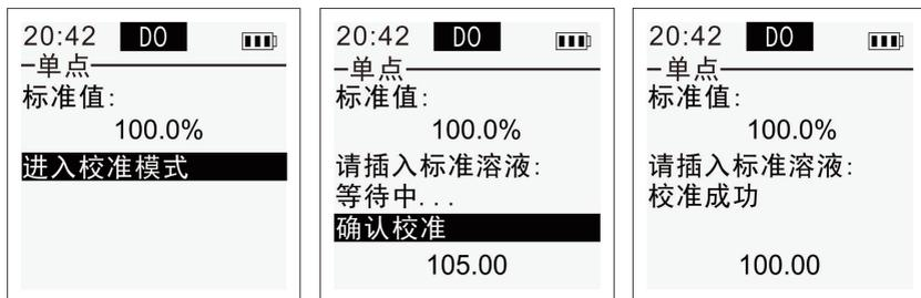
进入如上图校准界面后，把传感器置于饱和氧的溶液中，确认设定校准值为“100%”。选择“进入校准模式”按 键确认，下面会出现当前实际测量值，待测量值趋于稳定时，选择“确认校准”按 键后，
