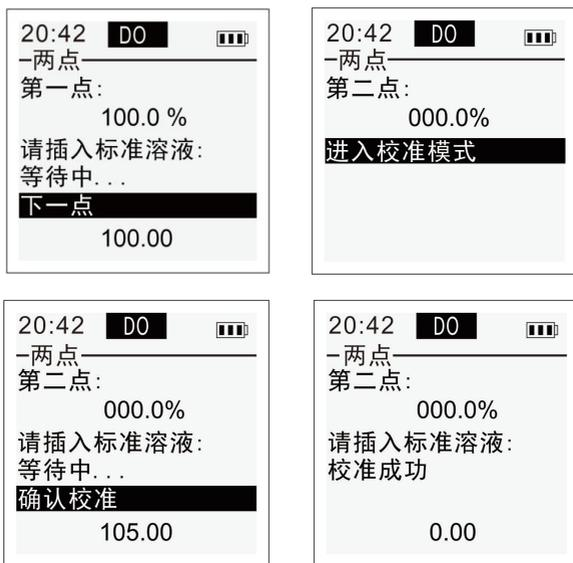
第一点校准，过程参考单点校准方式，第一点校准完成后选择菜单“下一点”，按
